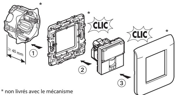
Le montage sur support modulaire se fait avec l'adaptateur Réf. 802 99 (2 modules).
